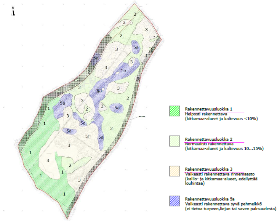
Kuva 16. Asemakaavan tueksi laadittu rakennettavuusselvitys (Geosolver Oy 2025)
